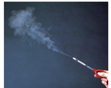
簡易的に煙を発生させることのできる器具です。煙を発生させることで、空気の流れを可視化することができ、換気の評価することができます。
